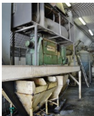
Le système de trituration coûte 200 000 euros pour une transformation de 1 000 tonnes de graines de soja par an. ©Ifip
