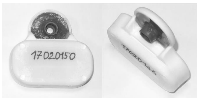
Figure 1 – Boucle (femelle) de fixation de l'accéléromètre à l'oreille (prototype développé par la société Rf-Track)
