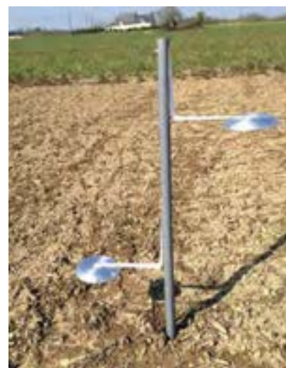
Piquet St Rambert sur lequel sont fixés des pièges ammoniac pour les mesures d'émissions gazeuses au champ
