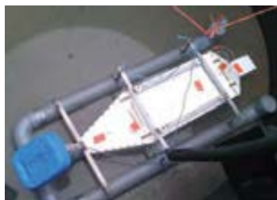
Tunnel flottant utilisé pour la mesure des émissions gazeuses d'une cuve de stockage découverte
