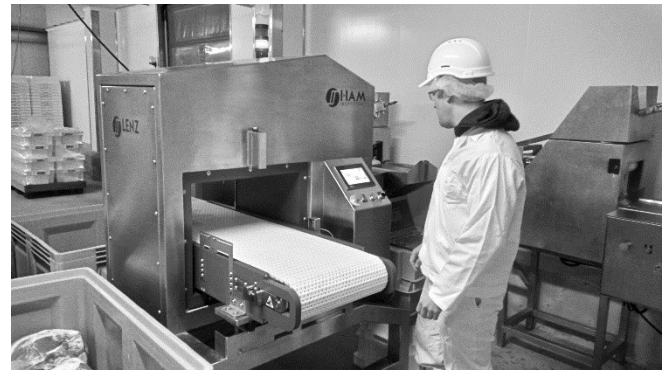
Figure 1 – Scanner à induction magnétique : Ham-Inspector II™
