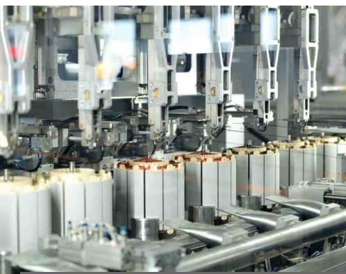
▲ DES ROBOTS DE BOBINAGE DES FILS DE CUIVRE permettent de créer les rotors des moteurs.
