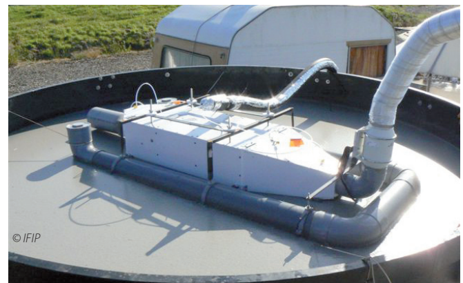
Pour mesurer les gaz dans une fosse de stockage, il est possible d'utiliser un dispositif de type «tunnel» en ventilation dynamique. Celui-ci flotte à la surface du lisier. Les concentrations gazeuses de l'air entrant et sortant sont enregistrées par un analyseur de gaz.
