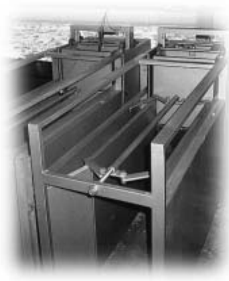
Système d'alimentation ACEMO 48, utilisé dans les stations de contrôle de performances
